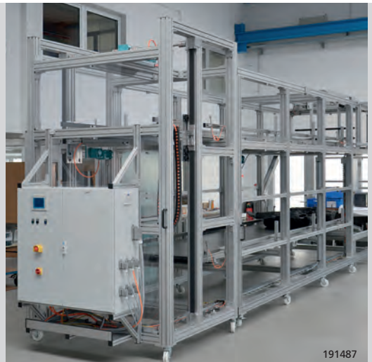
Mobile Pufferstrecke mit Schutzumhausung
