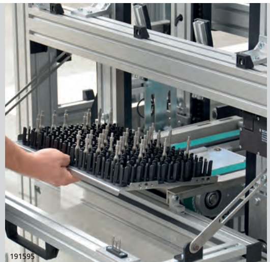
Beladeklappe mit aufgesetzten Führungsschienen zum Be- und Entladen des Speichers, inkl. elektr. Sicherheitszuhaltung
