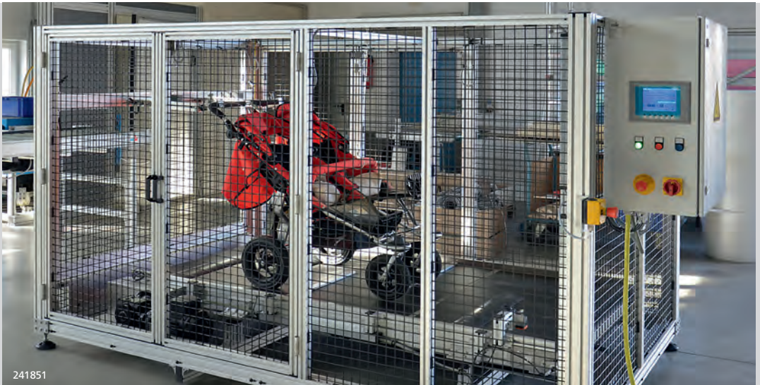
Individuelle Schutzeinrichtung für Prüfvorrichtung für Kinderwagen
