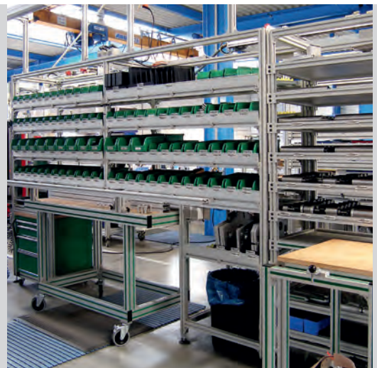
Arbeitsplatz nach „Kanban-Prinzip“ zur produktivitätssteigernden Entkopplung von Montage und Versorgungslogistik
