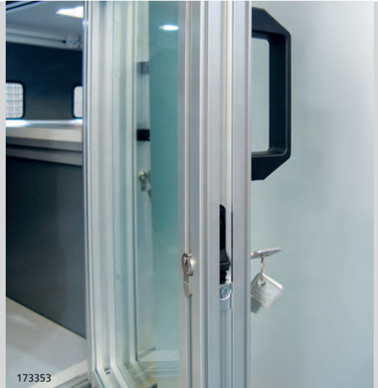
Flügel­tür mit Zylinderschloss, Füllung umlaufend gefalzt und in kleiner Profilnut fixiert, ohne Dichtgummi
