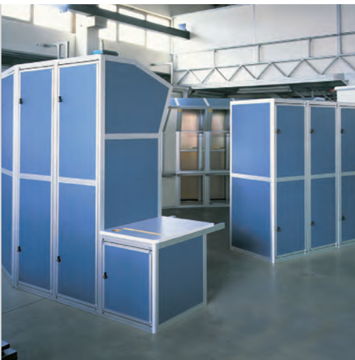
Schutzeinhausung mit Füllungen aus blau lackiertem PVC
