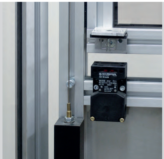
Sicherheitsschalter mit getrennter Betätigung für seitlich verschiebbare, drehbare und abnehmbare Schutzeinrichtungen
