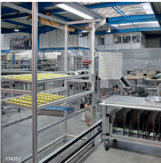
Montagestation inkl. KLT-Rückführung sowie Energie- und Druckluftversorgung
