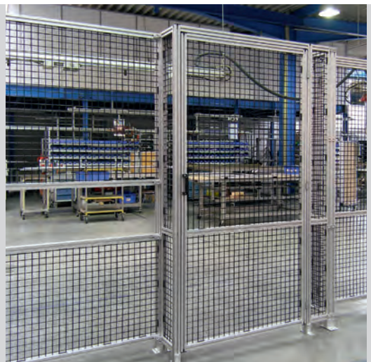
Füllung Schweißgitter schwarz pulverbeschichtet
