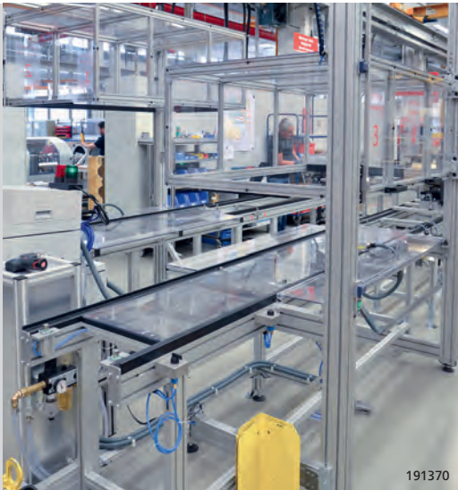
Montagestation mit Zuführung über Zweistrangförderer und Schutzeinhausung
