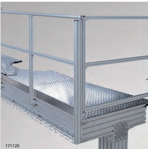
Freitragende Montagebühne mit einseitigem Geländer, Anfahr Gummi auf der Montageseite und Gitterkabelrinne auf der Geländerseite
