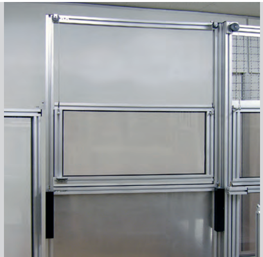
Hubtür einfach, manuell austariert über Umlenkung und Gegengewicht
