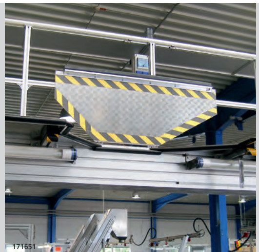
Montagebühne mit schwenkbarer Wartungsklappe im Podestboden
