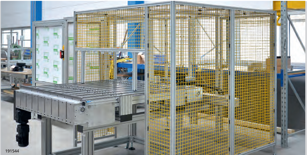
Schutzumhausung für Messstation durch umlaufende Feldrahmen mit Schweißgitter im kundenspezifischen RAL-Ton
