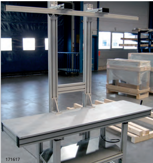
Montagevorrichtung aus Profilserie 50, manuell höhenverstellbar über Handkurbel, Belastung 600 kg
