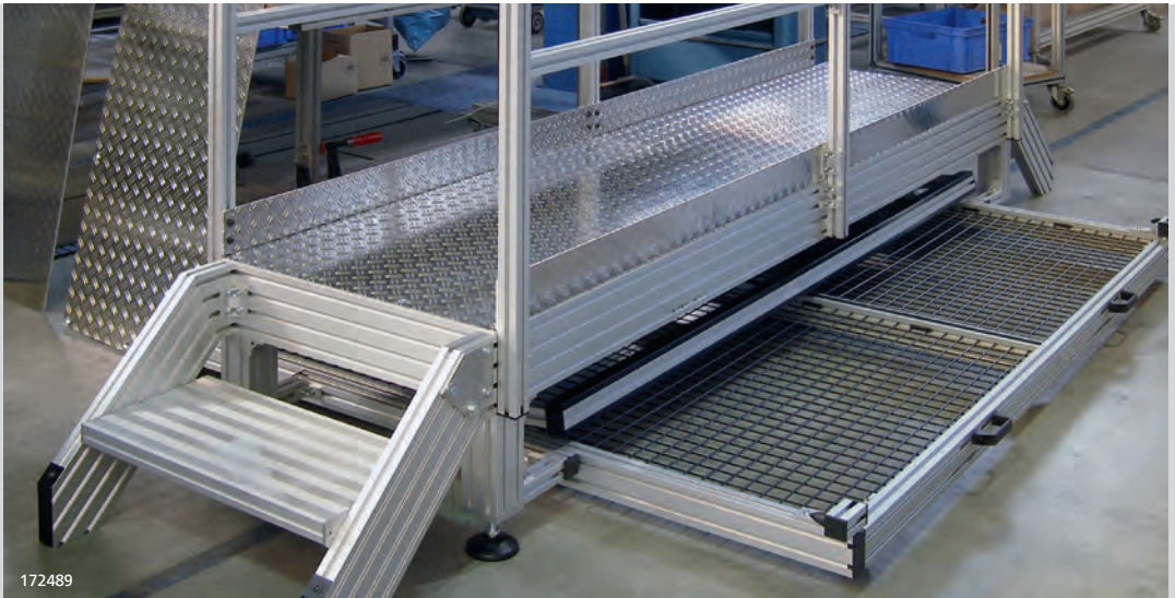
Podest aus Profilen der Serie 40, Trittfläche aus Rautenduettblech mit ausfahbarem Rahmen mit Schweißgitterfüllung
