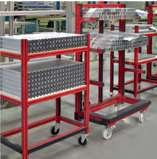
Bereitstellungswagen aus rot lackierten Profilen der Serie 40
