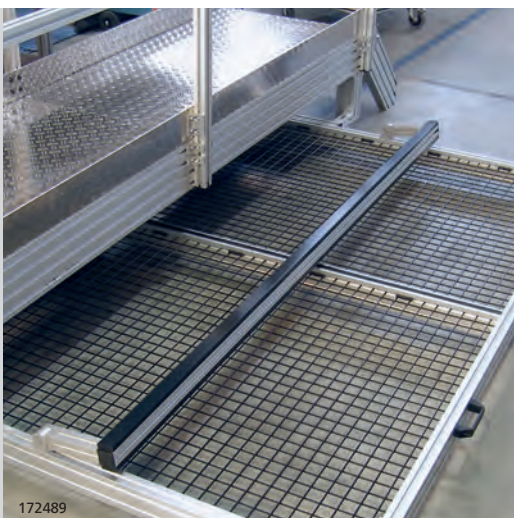
Befestigung des Schweißgitters mit Keilklemmen
