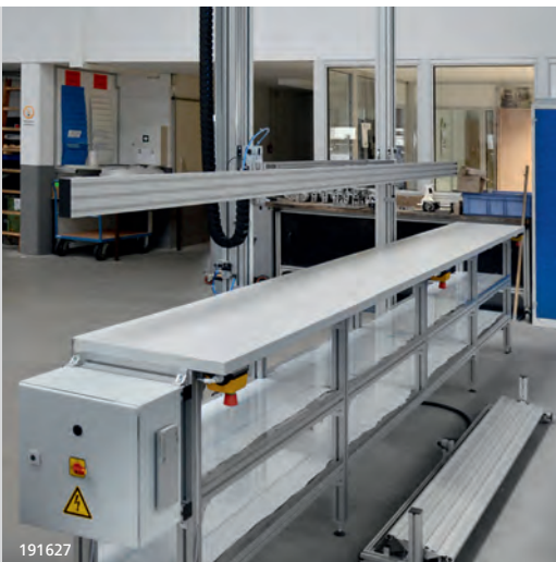
Montage- und Prüfarbeitsplatz inkl. Linearmodul zum Produkthandling und Steuerung über Fußpedal
