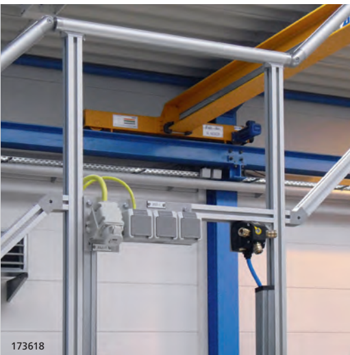
An die Geländerpfosten aus der mk Profiltechnik können Komponenten wie z.B. die Elektroversorgung angebracht werden
