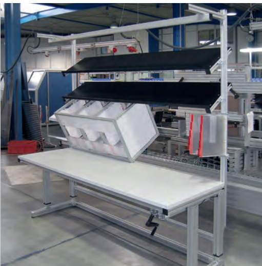
Ablagesysteme, Blechablage schwarz ist schwenk- und tiefenverstellbar
