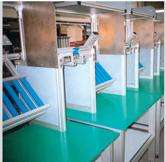
Kommissioniertische mit integrierter Rollenbahn, pneumatisch absenkbar
