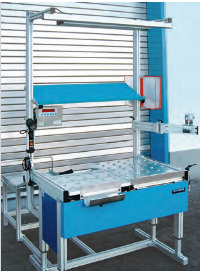
Verpackungstische mit integrierter Waage und Rutsche
