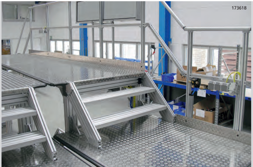
Arbeitsbühne links und rechts aus Profilsérie 40 mit Anfahrtschutzgummiprofil auf der Montageseite
