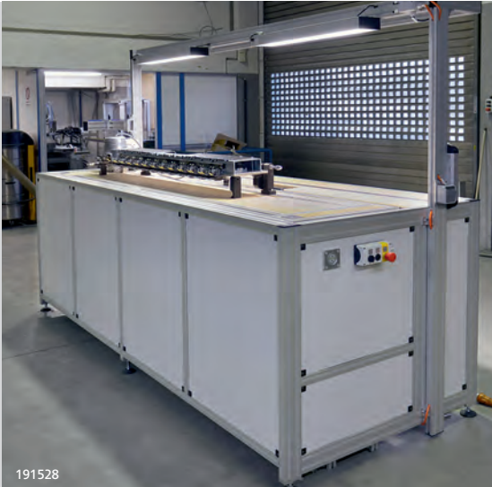
Montagearbeitsplatz mit Absenkvorrichtung über elektrisch angetriebene Hydraulikzylinder
