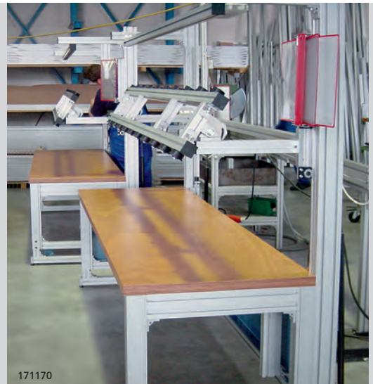
Arbeitstisch mit Linearverstellung, Tischplatte aus Buche Multiplex-Platte
