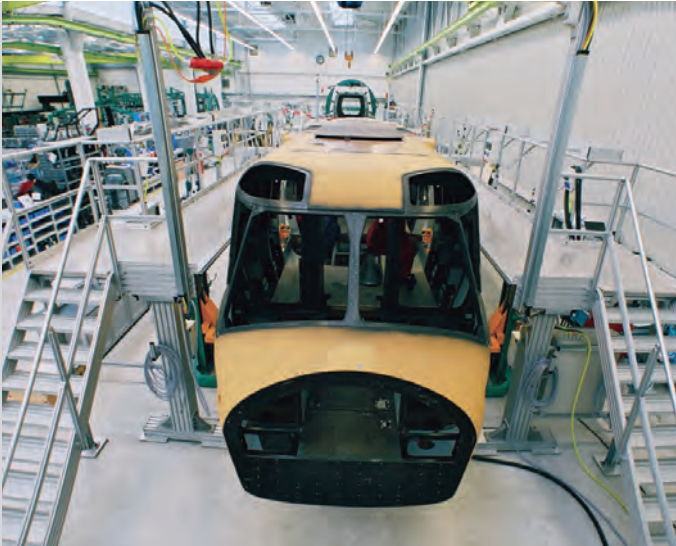
Arbeitsbühnen auf Luftkissen verfahrbar für den innerbetrieblichen Transport, zur Endmontage und Wartung von Helikoptern
