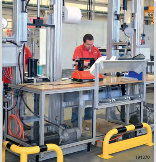
Montagearbeitsplatz mit integrierter Presse und Dokumentenablage
