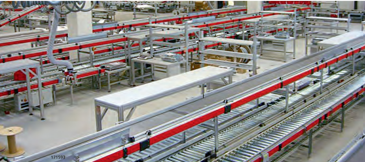
Arbeitsplatz „ET Sorter“ mit Kommissionier-Regalanlage und Rollenbahn
