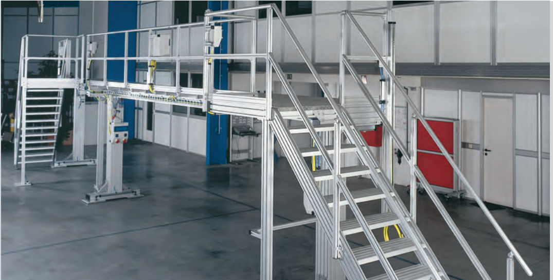
Montagebühne mit pneumatischer- sowie elektrischer Installation
