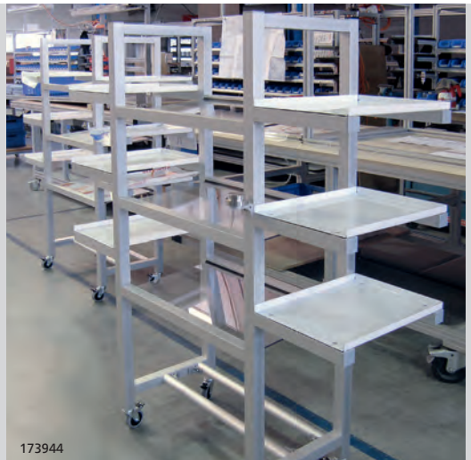
Materialbereitstellungswagen aus Reinraumprofilen der Serie 40 inkl. Acrylablagen
