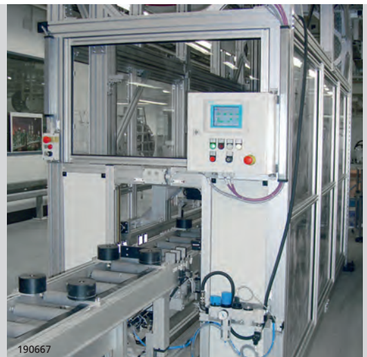
Schutzhäuser für Transferstrecke
