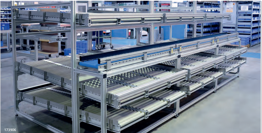
Kanban Systemarbeitsplatz – zur manuellen Produktentnahme und Kommissionierung
