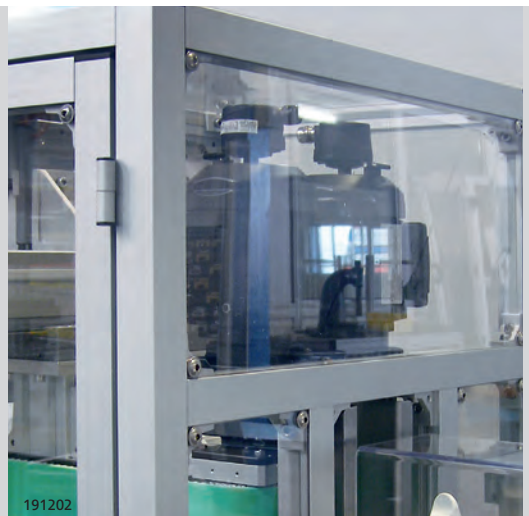
Acrylscheiben befestigt mit Winkeln und Unterlegblech
