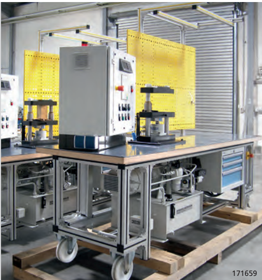
Messtisch aus Profilerie 40 und 50 mit Schubladenschrank
