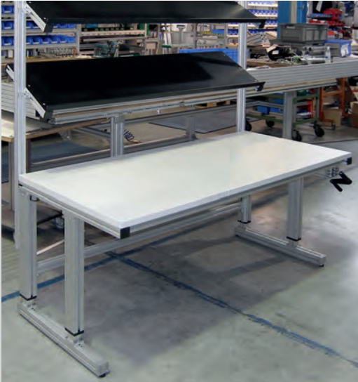
Teleskopierbare Tischpfosten mit manuell, hydraulischer Höhenverstellung über Handkurbel
