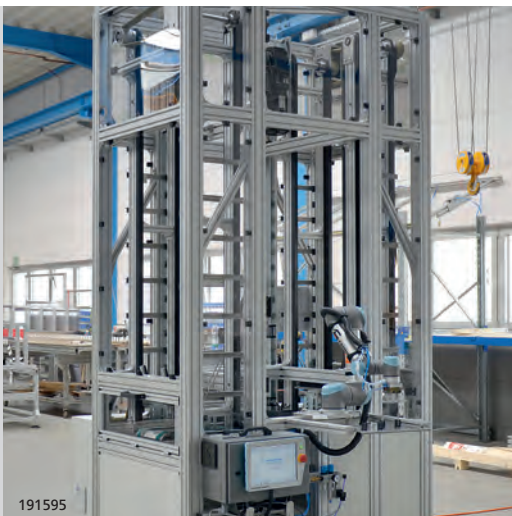
Schutzumhausung für Speichersystem mit Roboterhandlung
