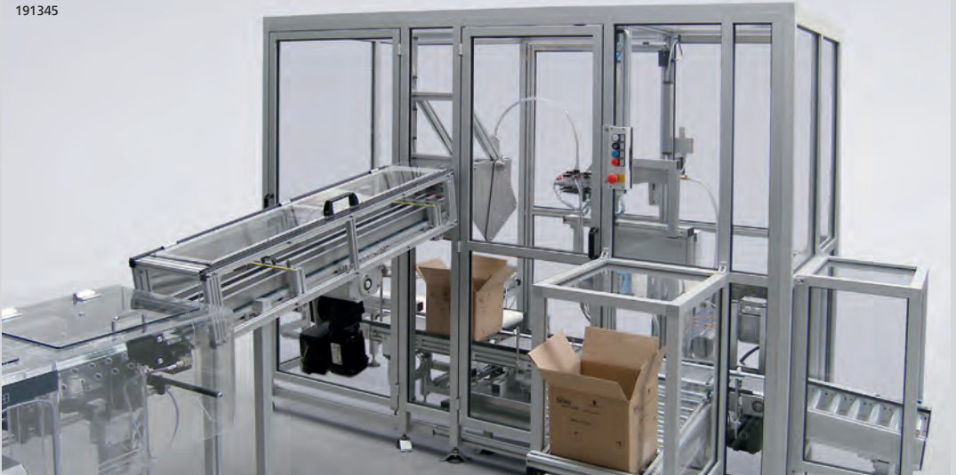
Schutzumhausung für den Reinraum aus Profilen der Serie 40 mit verschlossenen Profilnuten
