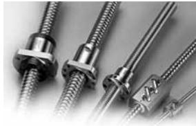
Mechanizmy śrubowo-toczne, zwane także śrubami kulowymi, składają się z wrzeciona i nakrętki z gwintem kolistym. W nakrętce znajdują się kulki poruszające się w zamkniętym obiegu. Śruby kulowe wraz z nakrętkami kulowymi należą do najczęściej stosowanych mechanizmów śrubowych w maszynach przemysłowych i precyzyjnych maszynach CNC. Umożliwiają zmianę ruchu obrotowego na ruch postępowy i odwrotnie. Charakteryzują się wysoką precyzją i wysokim współczynnikiem sprawności.
